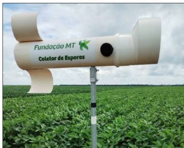
Figura 3. Instalação de coletores caça esporos, para verificar a disseminação dos patógenos e entrada dos mesmos nas áreas.
