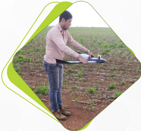
Uso de Vant na obtenção de imagens multiespectrais para a avaliação agrônômica de talhões comerciais de soja. Rondonópolis – MT.
